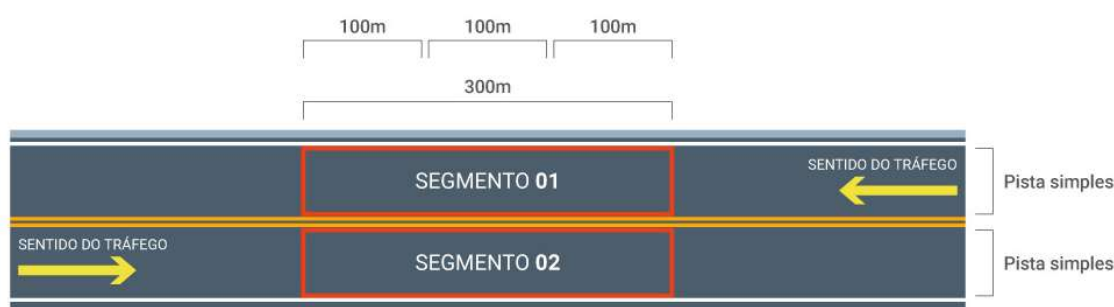
Figura 2 – Rodovia de pista simples por sentido
