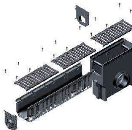
FIGURA 3: DETALHES TÍPICOS PARA CANAL DE POLIETILENO e POLIPROPILENO, COM GRELHAS EM POLIAMIDA REFORÇADA C250 OU DE FERRO FUNDIDO D400 OU E600, FIXADA COM TRAVAMENTO POR PARAFUSOS. ACESSÓRIOS: TAMPAS/SAÍDAS LATERAIS E CAIXA DE LIMPEZA/INSPEÇÃO
