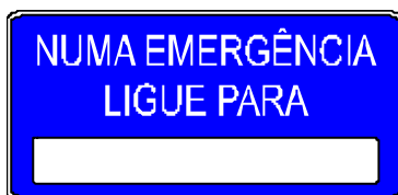
Figura 4.5.2 – Sinal complementar de identificação de serviços, com indicação de telefone de emergência
