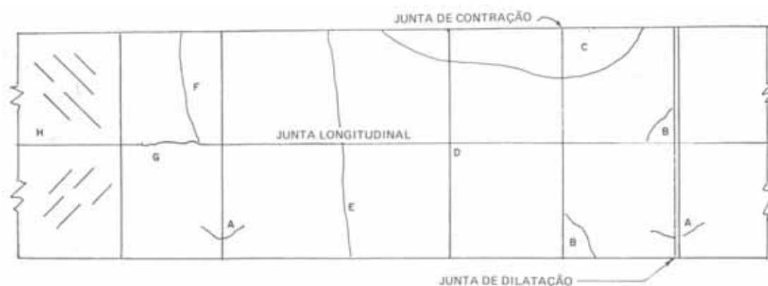
Figura 28 - Representação Estrutural dos Pavimentos Rígidos
