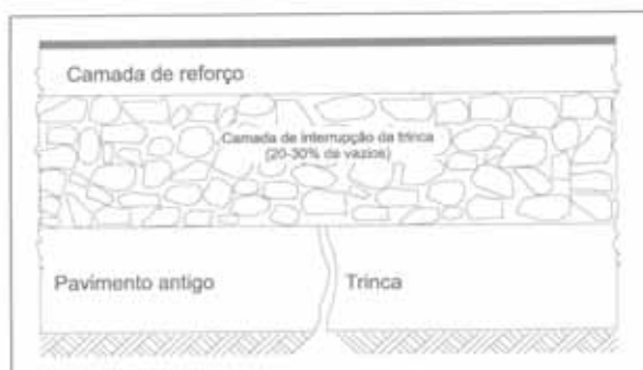
Figura 45 - Esquema de uma Camada de Interrupção do Trincamento
