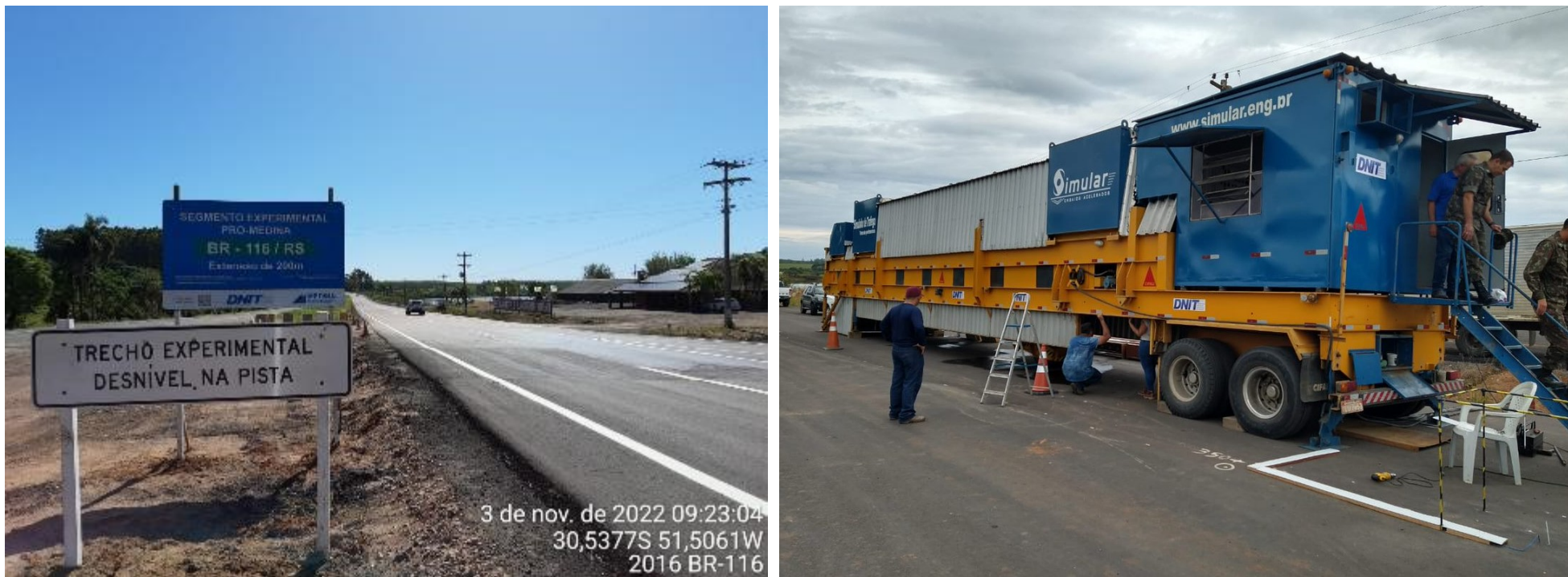
Figura 14: Placa do Trecho 1 e Simulador de Tráfego na BR-116/RS.
