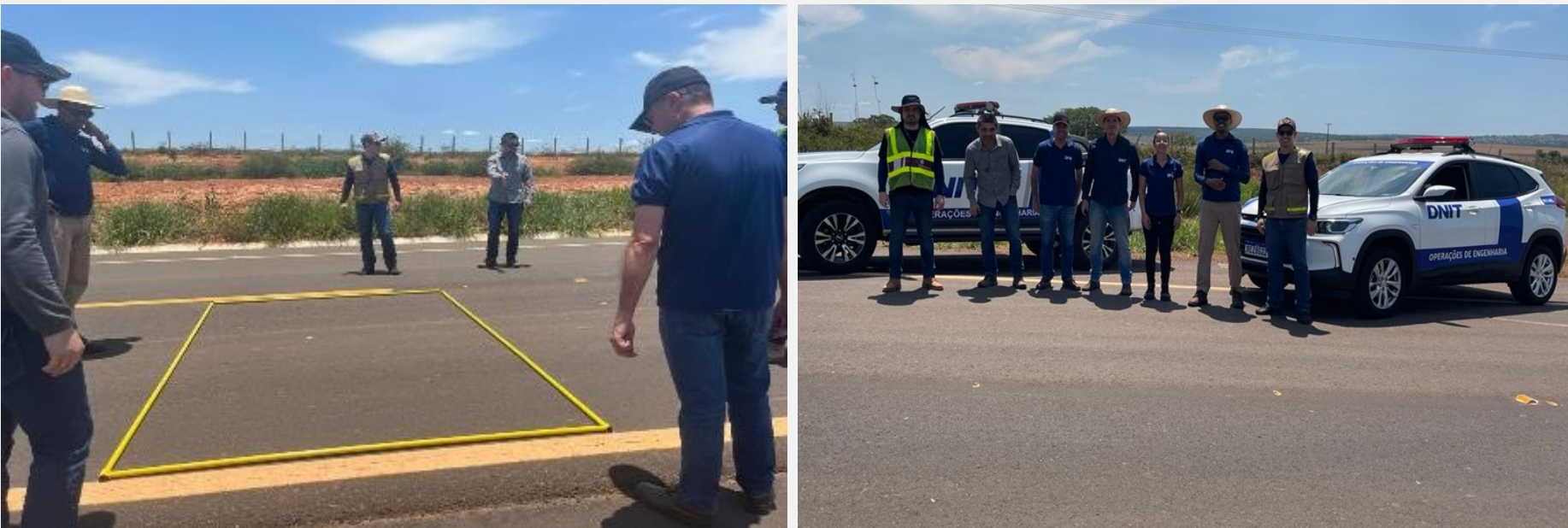
Figura 13: Levantamento de área trincada na BR-419/MS.
