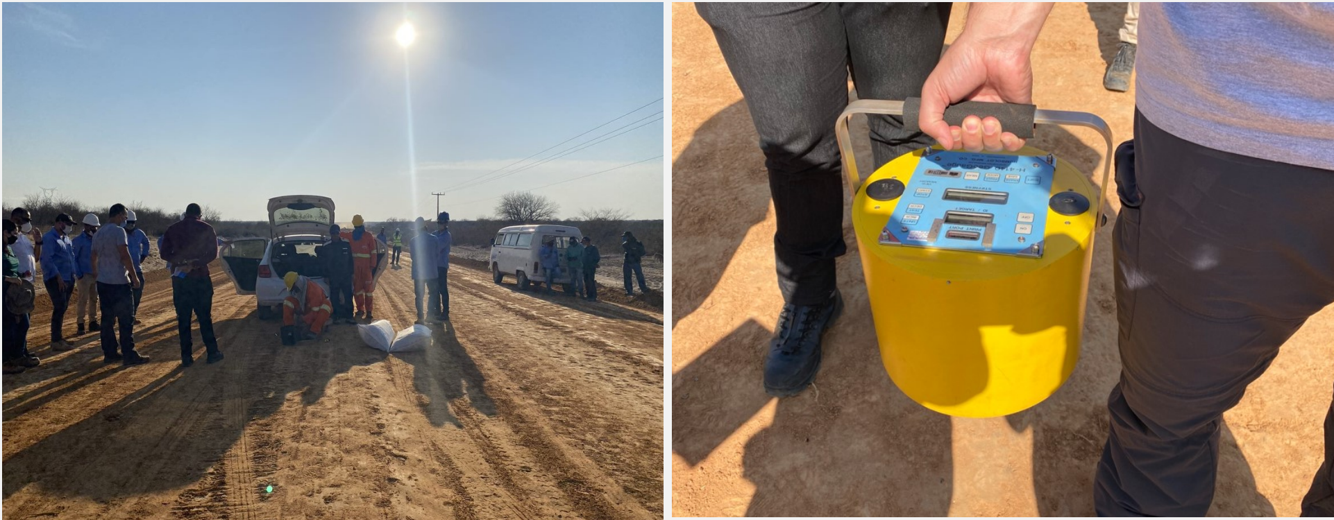
Figura 7: Controle de execução na obra da BR-235/BA e o uso do equipamento Geogauge.
