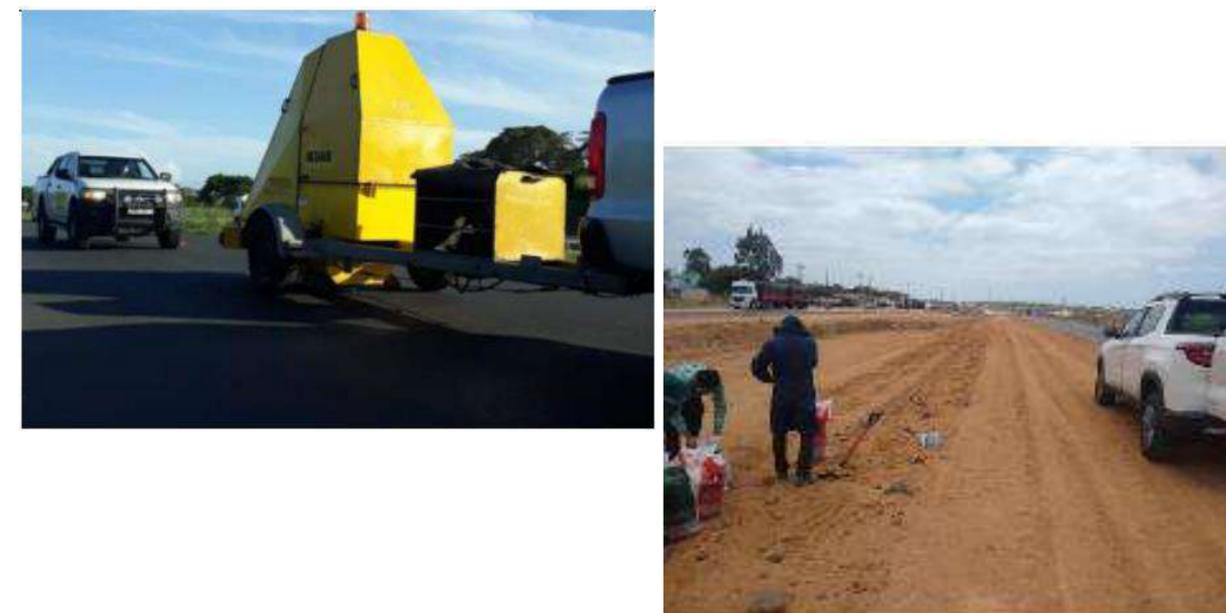
**Figura 8:** Ensaios no tempo zero na BR-020/CE (4º Anel Viário) e coleta de materiais.
