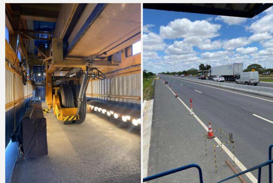
**Figura 9:** Simulador de tráfego e pista no trecho da BR-116/BA.
