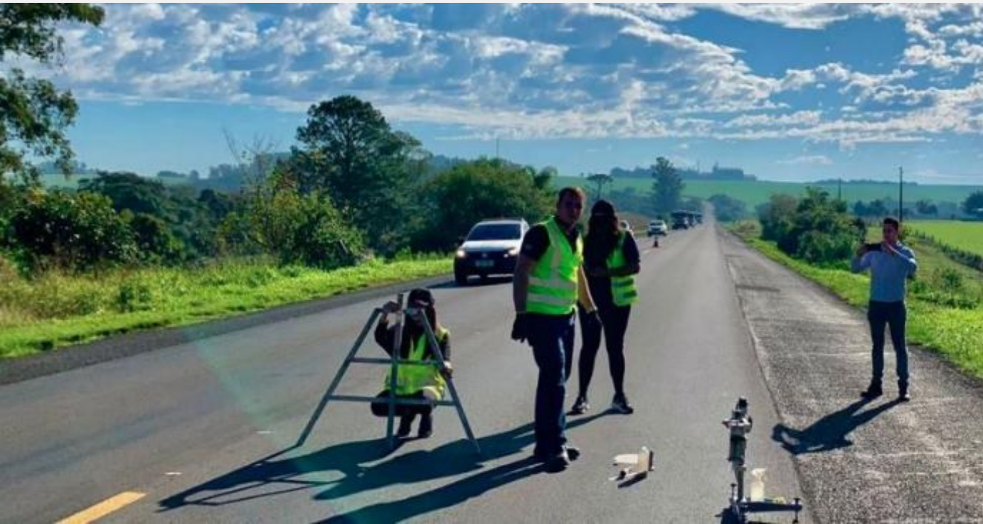
Figura 8: levantamentos de ATR com treliça metálica.
