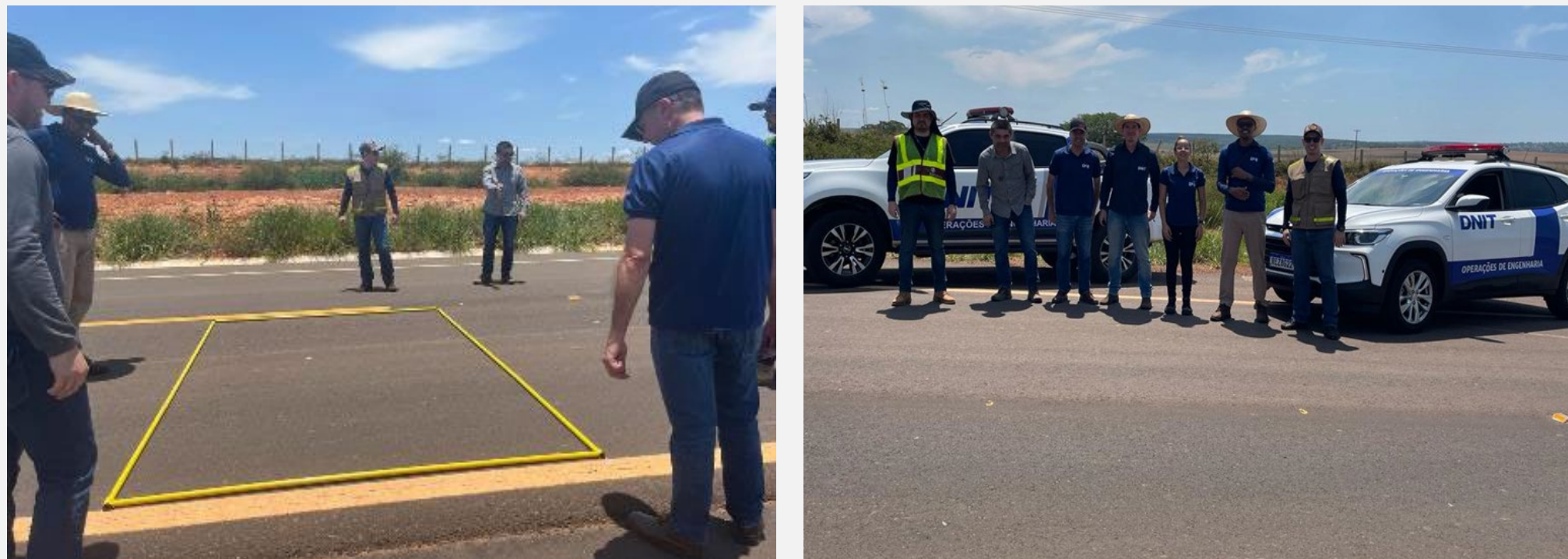
Figura 22: Levantamento de área trincada na BR-419/MS.
