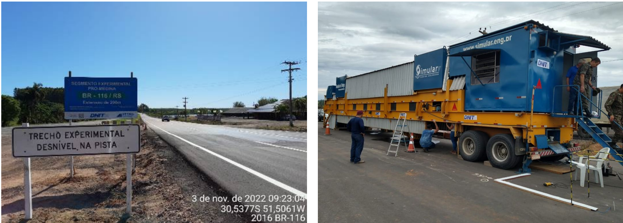
Figura 23: Placa do Trecho 1 e Simulador de Tráfego na BR-116/RS.
