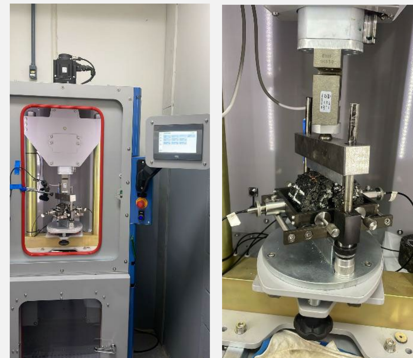
Figura 6: Ensaio de fadiga à compressão diametral.
