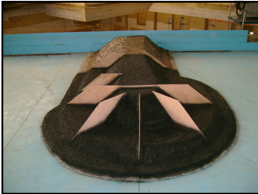
Figura B1 – Montagem do núcleo (notar os moldes para a colocação da berma)
