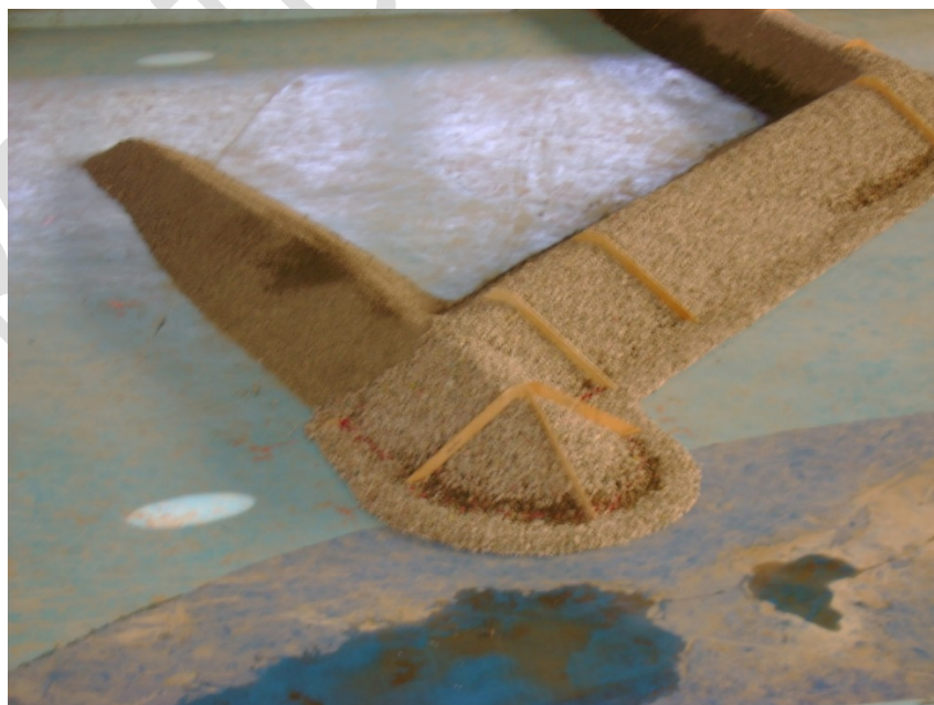
Figura A2 – Núcleo e subcarapaças já montadas (notar os moldes para colocação da carapaça)
