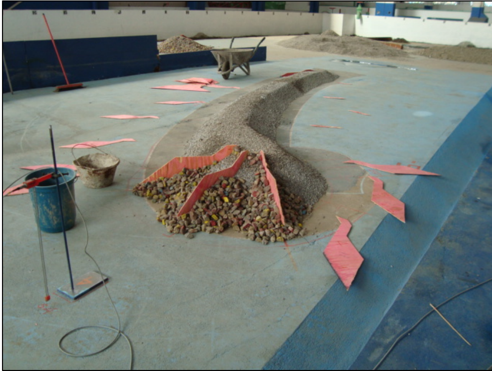
Figura 23 – Início de montagem da carapaça do molhe, no trecho do cabeço
