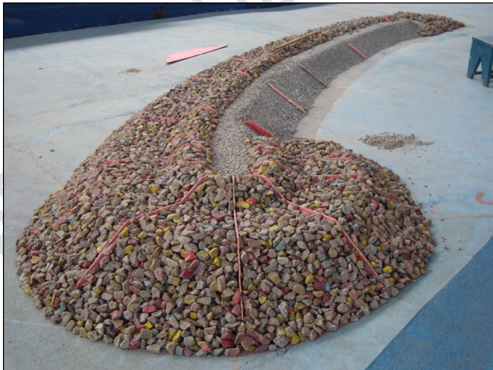
Figura 23 – Início de montagem da carapaça do molhe, no trecho do cabeço
