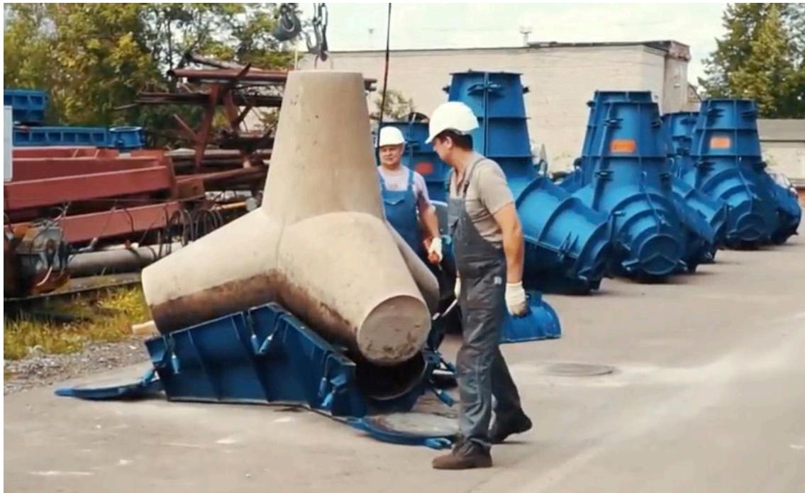
Figura 4 - Confeção de tetrápode para molhe
