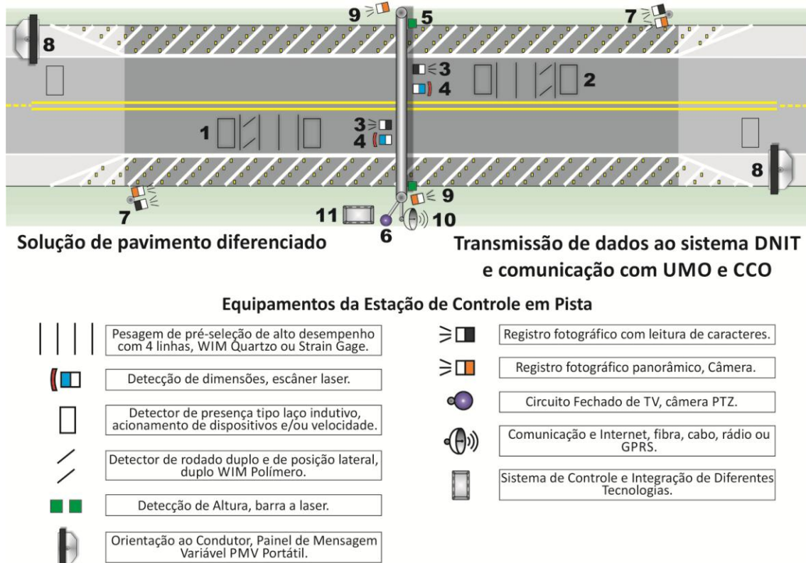
Figura 1 – Esquema de solução tecnológica para ECP em rodovias de pista simples Estação de Controle em Pista
