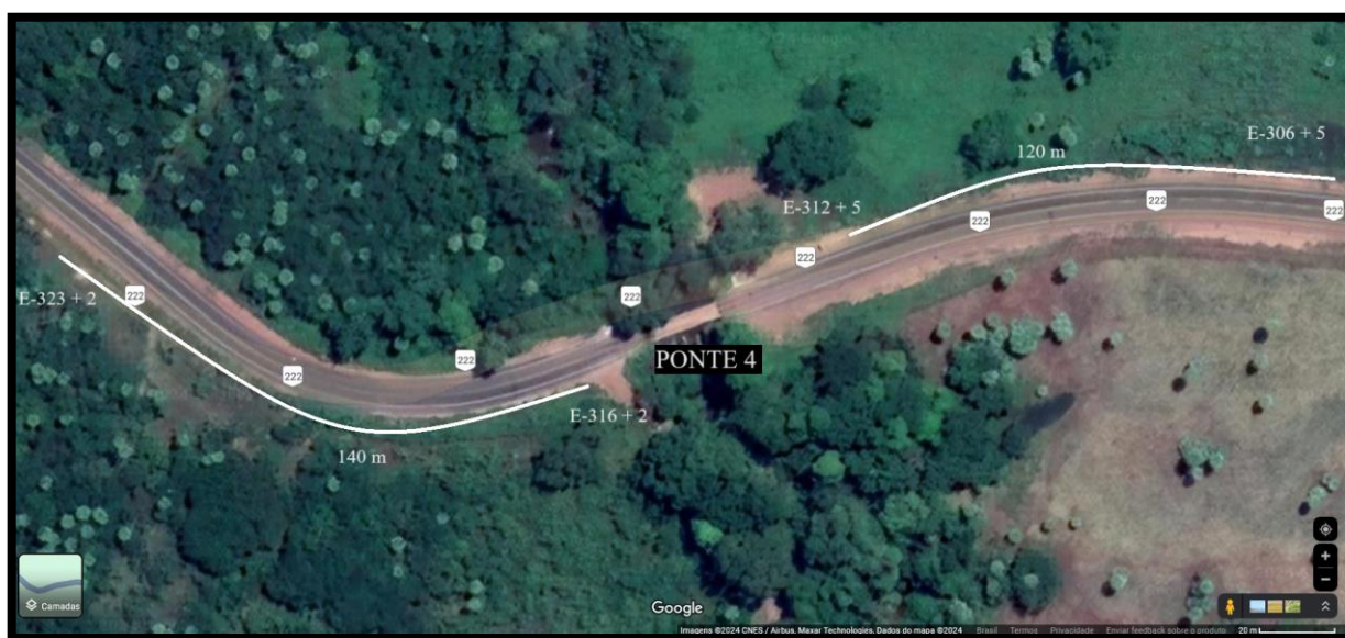
Figura 1. Prolongamento das defensas na ponte 4.
