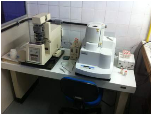
Figura 3: Analisadores térmicos TGA e DTG (simultâneo DTA e TG).
