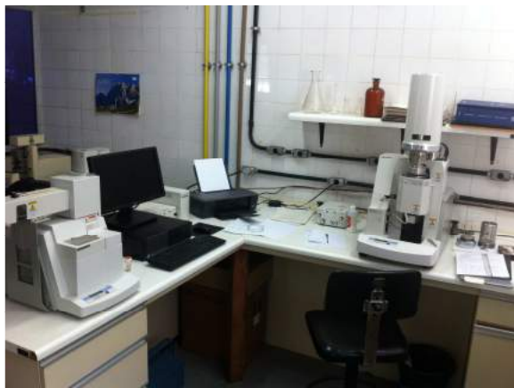
Figura 1: Analisadores térmicos DSC e TMA. Figura 2: Calorímetro.
