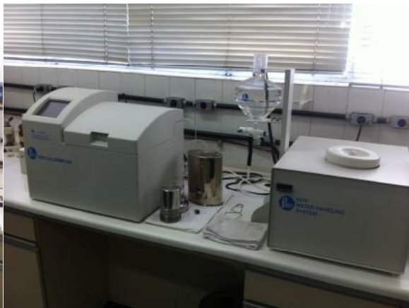
Figura 1: Analisadores térmicos DSC e TMA. Figura 2: Calorímetro.
