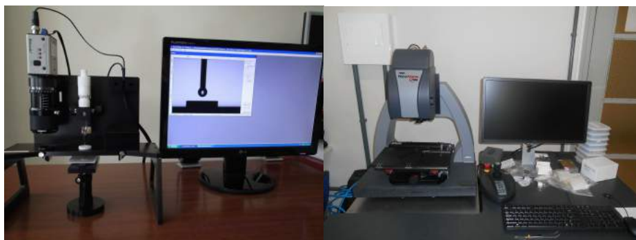
Figura 2: Goniômetro Mitutoyo para medida da molhabilidade (lado esquerdo). Equipamento Zygo 7000 para quantificar a rugosidade em 3D por interferometria (lado direito).
