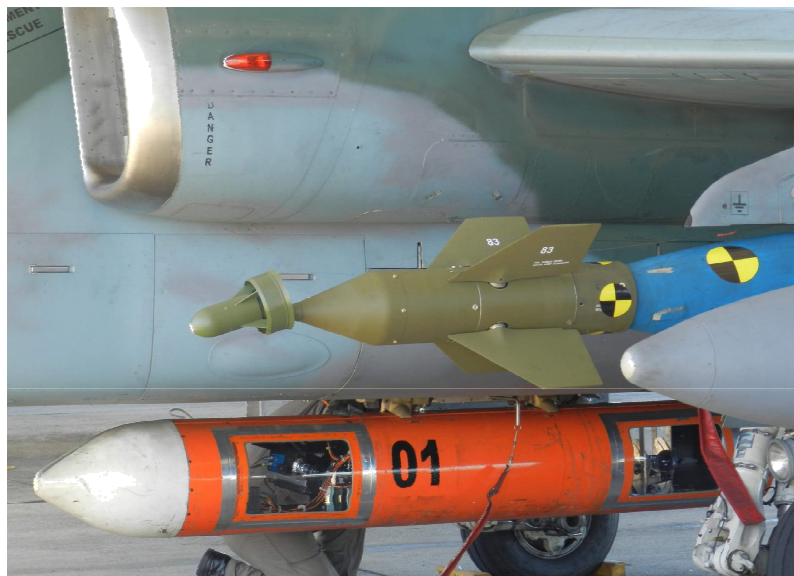
Fig. 2- Casulo foto instalado na aeronave A1-A
