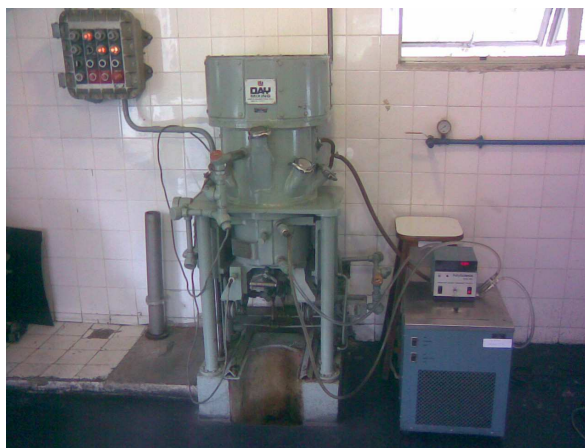
Figura 1: Misturador vertical tipo sigma para processamento de materiais compósitos de matriz polimérica bicomponente.
