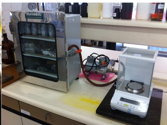
Figura 4: Câmara para armazenar amostras a vácuo e balança analítica.
