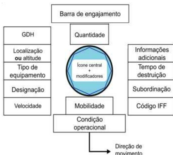
Figura 9: Disposição dos amplificadores possíveis para símbolos de equipamentos e viaturas. O octógono e os retângulos ao redor de cada campo não são desenhados, estando presentes apenas como referência
