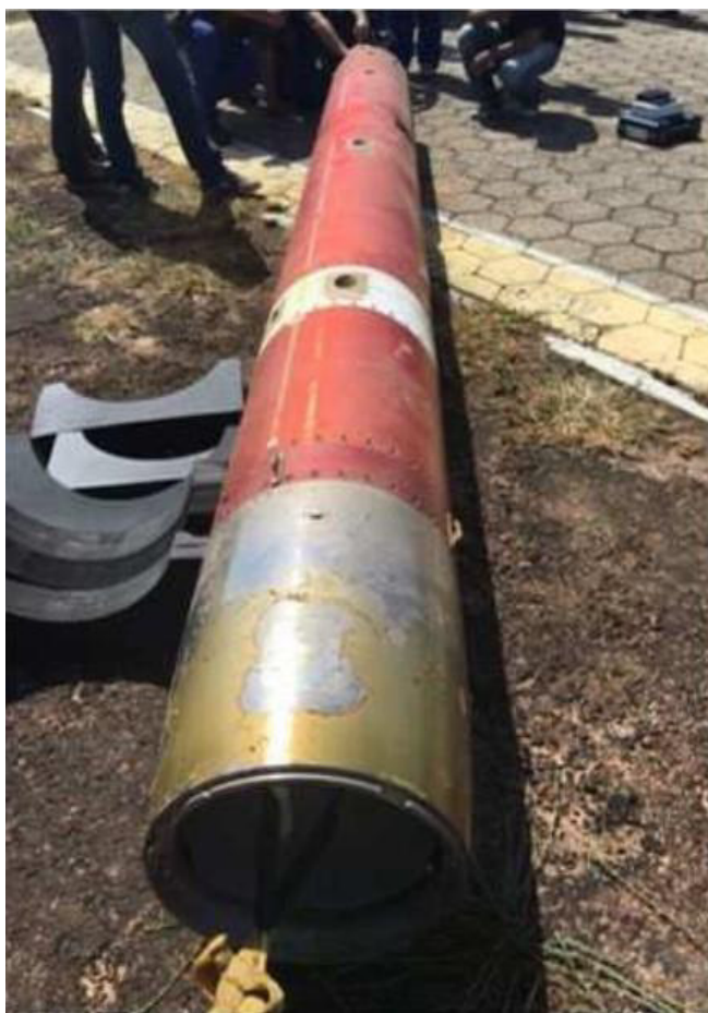
Figura 34 – VSB-30 Carga útil recuperada após o acidente
