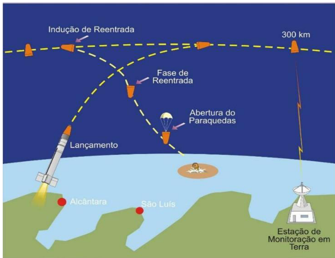
Figura 29 – Representação Esquemática do SARA - Lançamento, órbita e recuperação
