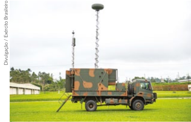
Carro de combate de apoio à comunicação.
