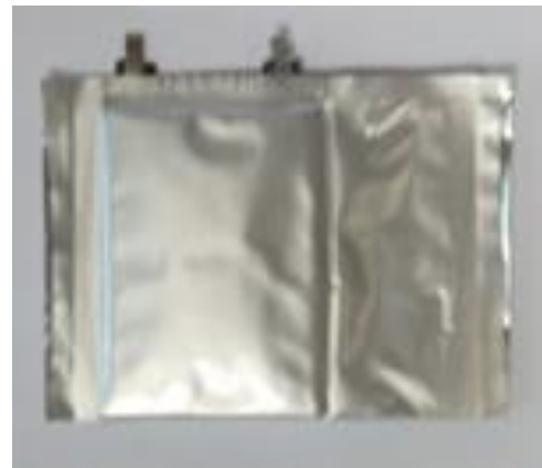
Pouch cell com contatos soldados
