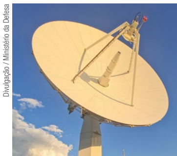
Site de Formosa: diâmetro de 11 metros, com capacidade de transmitir e receber dados de satélites ópticos e RADAR nas bandas X, Ka e S.
