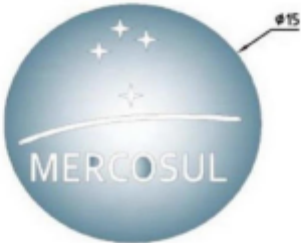
Figura 5 - Marcas d'água de segurança da película retrorrefletiva
