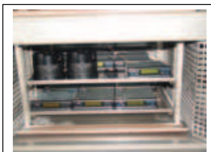
Ensaio de confiabilidade de produtos eletrônicos em câmara de ciclagem térmica
