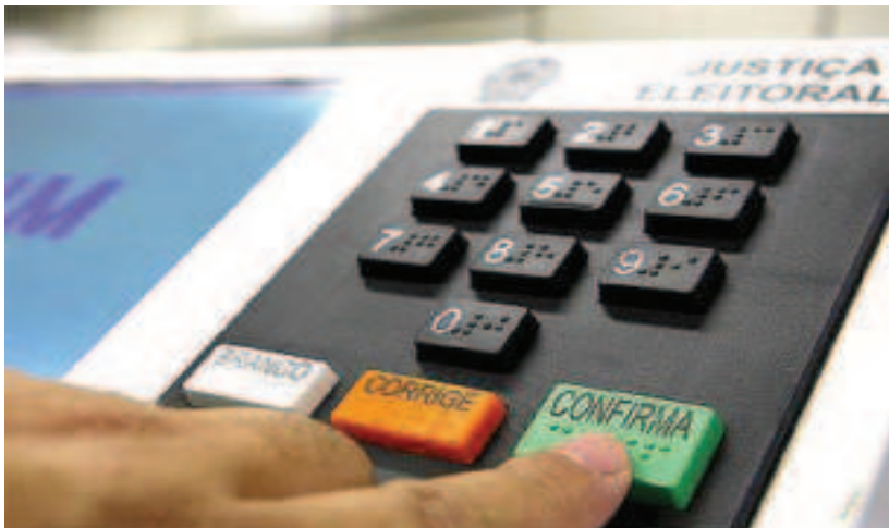
Figura 1 – Urna Eletrônica: painel frontal do Terminal do Eleitor
