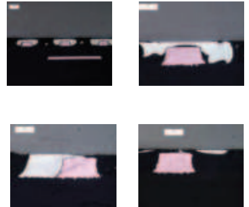
Figura 6. Imagens de secção transversal obtidas por microscopia óptica das interfaces de ACF de diferentes condições: (b) e (c) 2 bar de pressão (d) 3 bar de pressão; (e) 4 bar de pressão, com 190 °C e 260 °C de temperatura utilizada na termocompressão.
