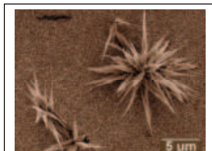
Figura 2. Imagem de microscopia eletrônica de varredura de um filme de cobre tratado com corrente elétrica
