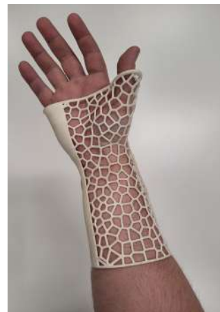
Material impresso em 3D em poliamida customizado ao paciente e otimizado com base no biomimetismo.
