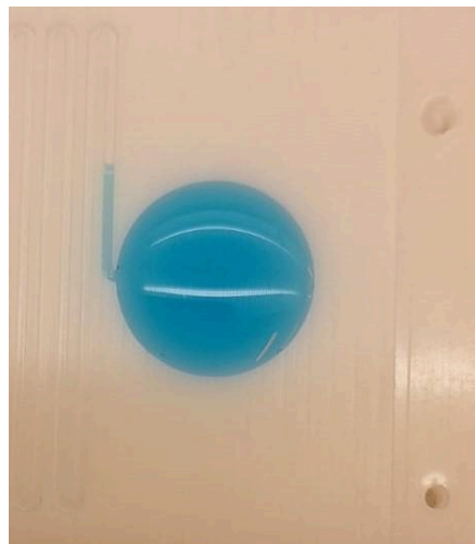
Figura 1 - Microcanal em poliacetal com tratamento de plasma de O_2
