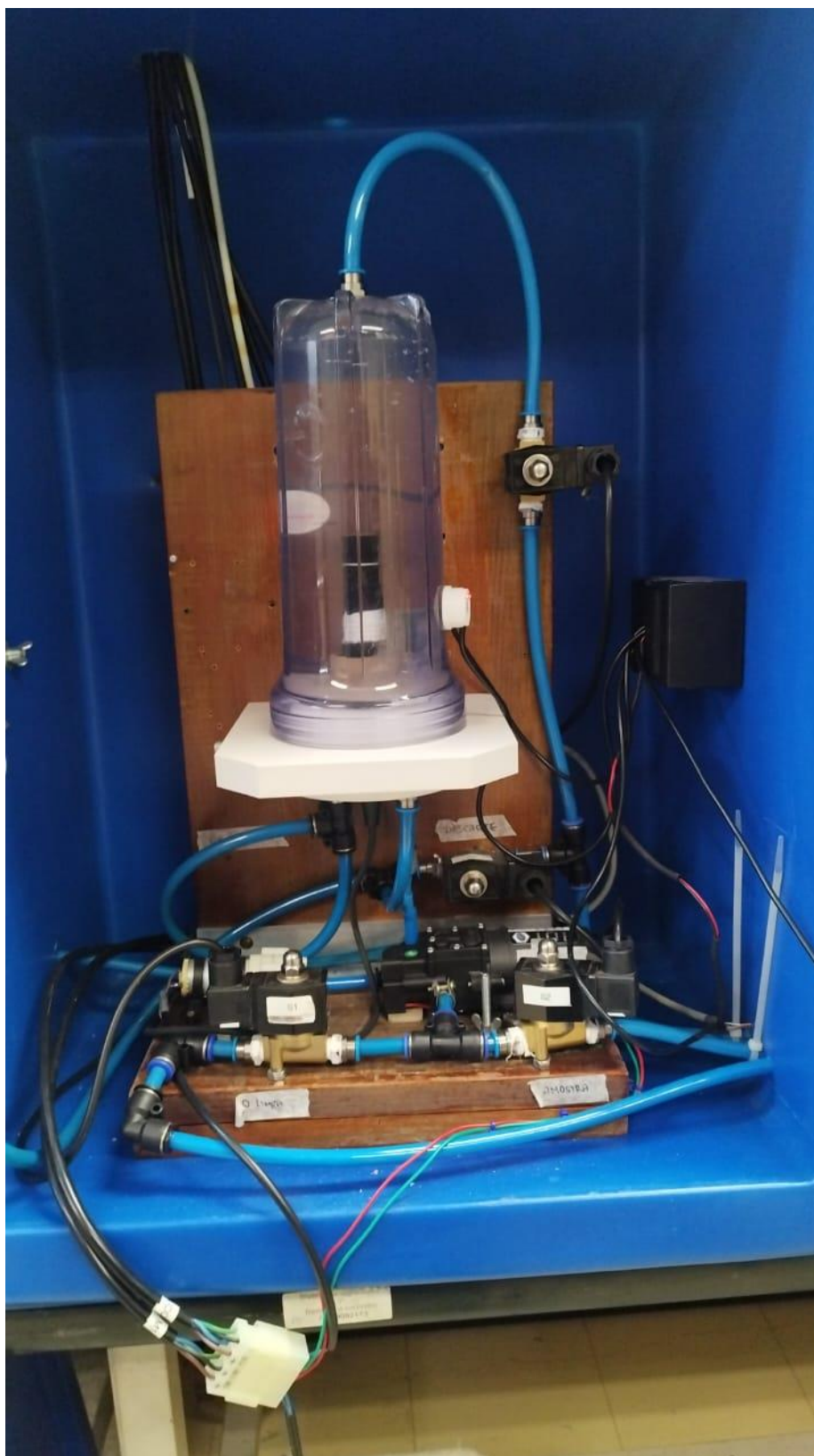
Figura 2 – Setup da parte hidráulica e do sensor de oxigênio inserido no Biorreator
