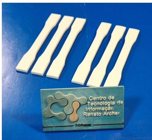
Figura 4. Corpos de prova impressos por SLS.
