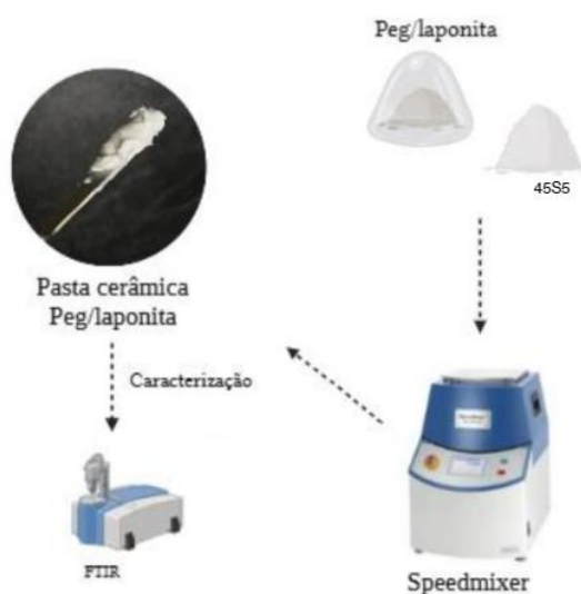
Figura 2. fluxograma do processo de formulação das pastas, caracterizadas por espectroscopia no infravermelho com transformador de Fourier (FTIR).
