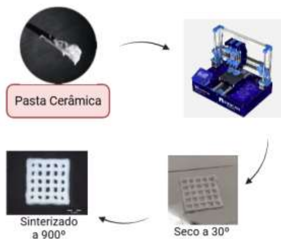
Figura 3 - Processo de impressão e sinterização dos scaffolds.
