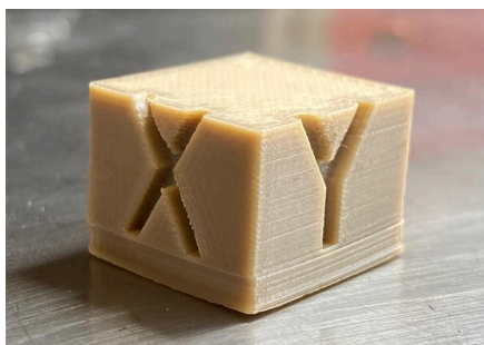
Figura 5 - Peça referência utilizando a técnica de annealing
