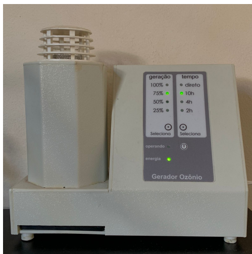
Figura 2. Gerador de ozônio tradicional. Fonte: Autoria própria.
