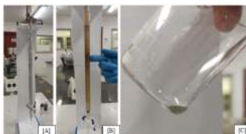
Figura 10 – (A) Preparação da coluna cromatográfica; (B) Separação dos corantes do extrato de mirtilo; (C) Primeira fração do extrato de mirtilo retirada da coluna cromatográfica.
