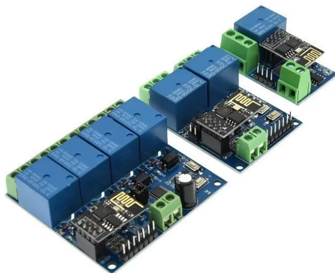
Figura 6. Exemplos de placas com 1, 2 e 4 relés, compatíveis com a ESP-01.
