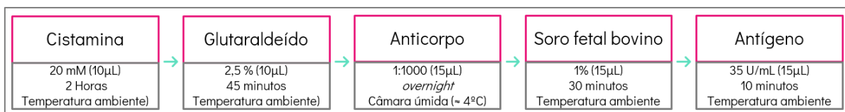
Figura 3. Esquema representativo do processo de modificação do eletrodo de trabalho.
