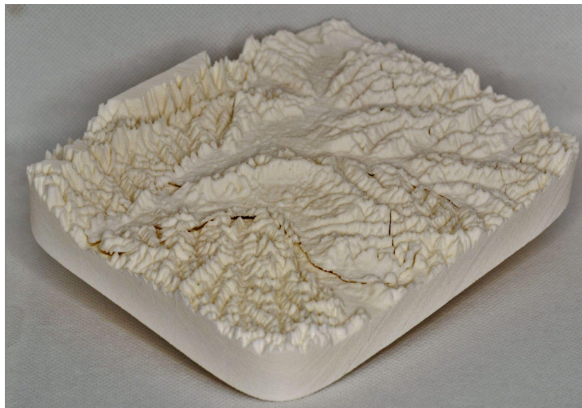
Figura 6 - Resultado final do modelo produzido por MA em Poliamida-12.
