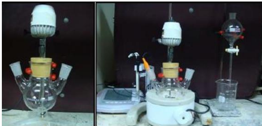
Figura 3 - Fotografia de um aparato destinado à lixiviação ácida de metais de interesse composto por balão de fundo redondo de três pescoços, agitador mecânico, termômetro e aquecedor térmico
