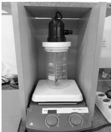
Figura 1- Sistema Fotolítico utilizado nos ensaios
