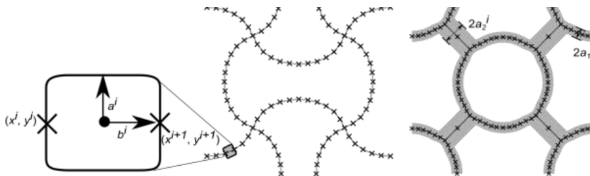
Figura 6: ilustração do design parametrizado por superelipses usado na otimização de topologia. Fonte:[12]
