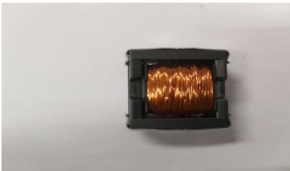
Figura 3. Transformador TR2 construído com núcleos de ferrite TDK modelo EFD 25/13/9 N87 com gap de 0,22 mm
