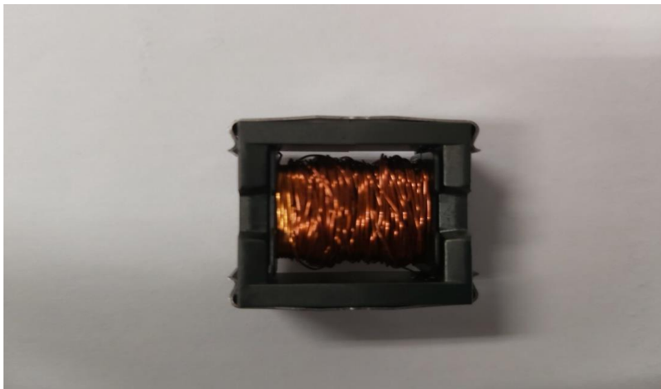
Figura 2. Transformador TR1 construído com núcleos de ferrite TDK modelo EFD 25/13/9 N87 com gap de 0,22 mm
