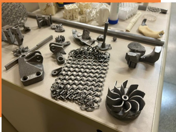
Peças em titânio fabricadas por manufatura aditiva no CTI Renato Archer
