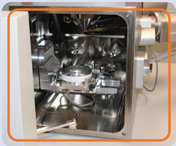
O microscópio eletrônico de varredura do CTI permite a visualização de estruturas nanométricas
