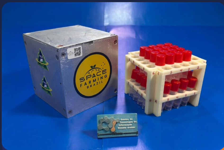
Cubesat da Rede Space Farming Brazil e a estrutura em ABS projetada e impressa no LApriint do CTI Renato Archer
