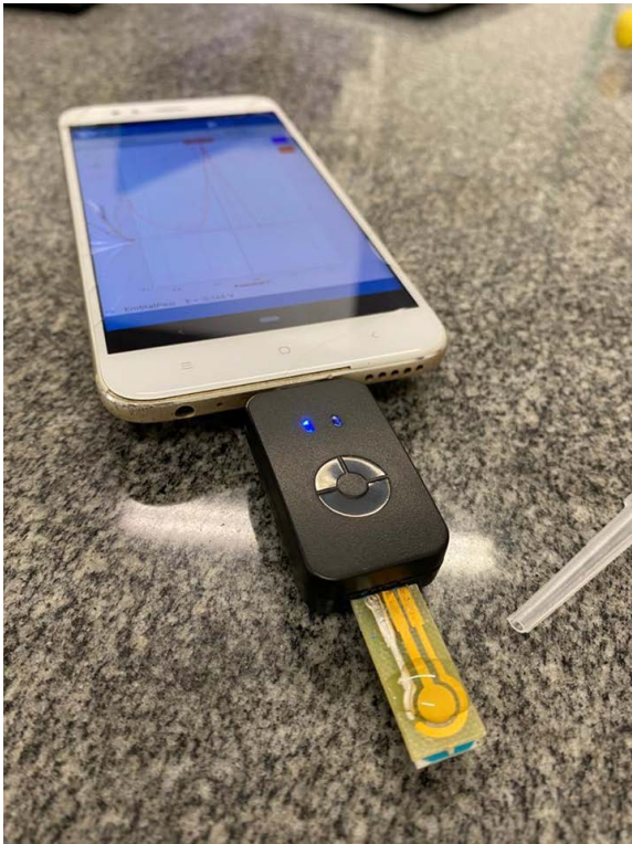
Imunossensor desenvolvido pelo CTI para teste rápido da Covid-19
