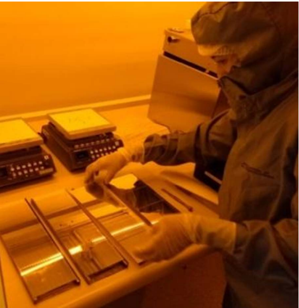
Preparação de 100 filtros Dicroicos em Sala Limpa
