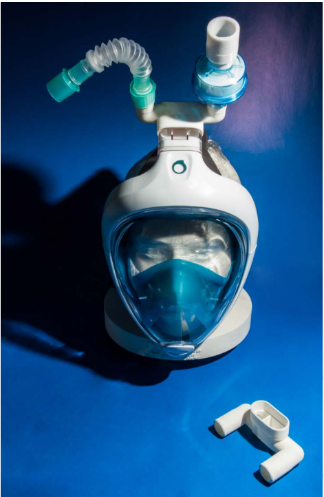
Dispositivos produzidos por impressão 3D para adaptação de máscara de mergulho para ventilação não invasiva em hospitais
