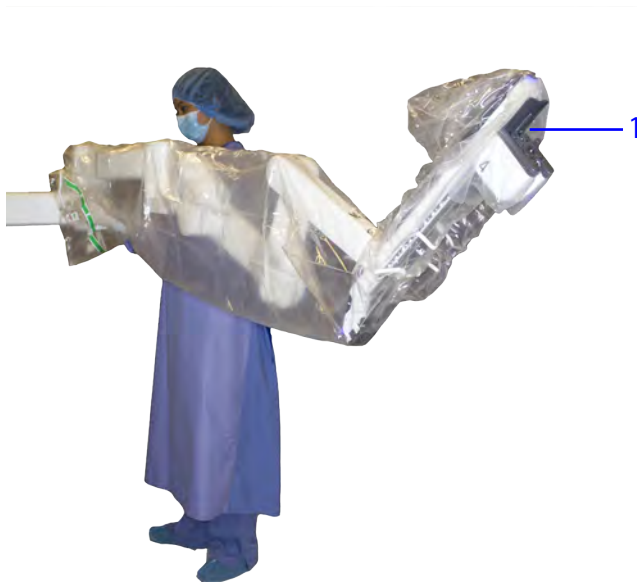
Figura 6.14 Instalação do Campo Cirúrgico do braço principal
