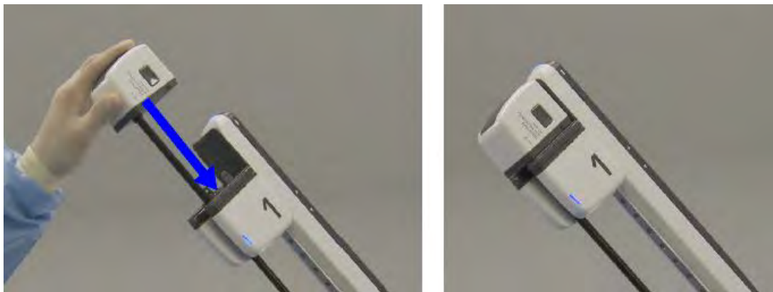
Figura 9.18 Introdução do instrumento dentro da cânula e do adaptador estéril
