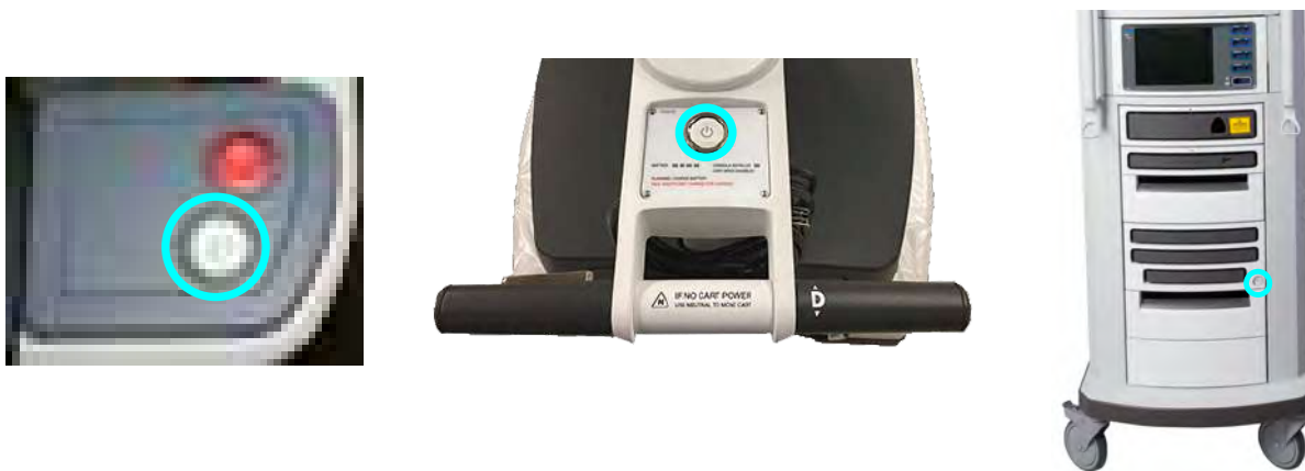
Figura 5.1 Botões de Alimentação – Console do Cirurgião, Carrinho do Paciente, Carrinho de Visão
