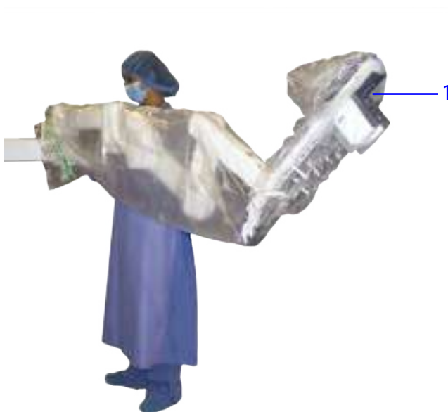
Figura 6.14 Instalação do Campo Cirúrgico do braço principal
