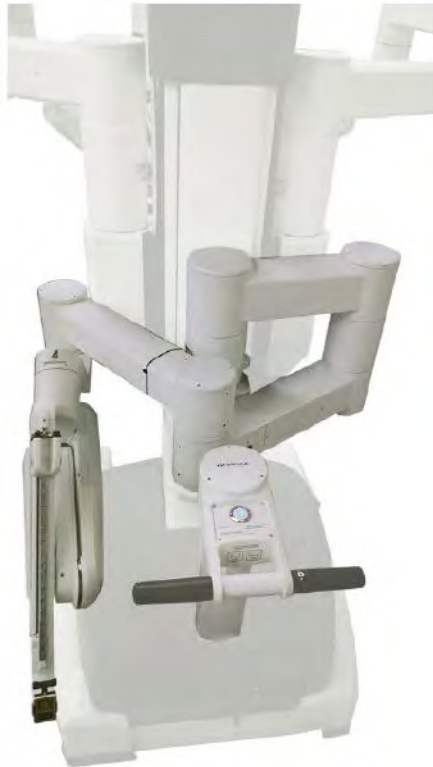
Figura 9.9 Exemplo de recolhimento do braço 4
