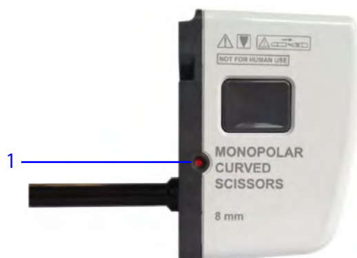
Figura 9.25 Indicador do número máximo de utilizações em um instrumento expirado
