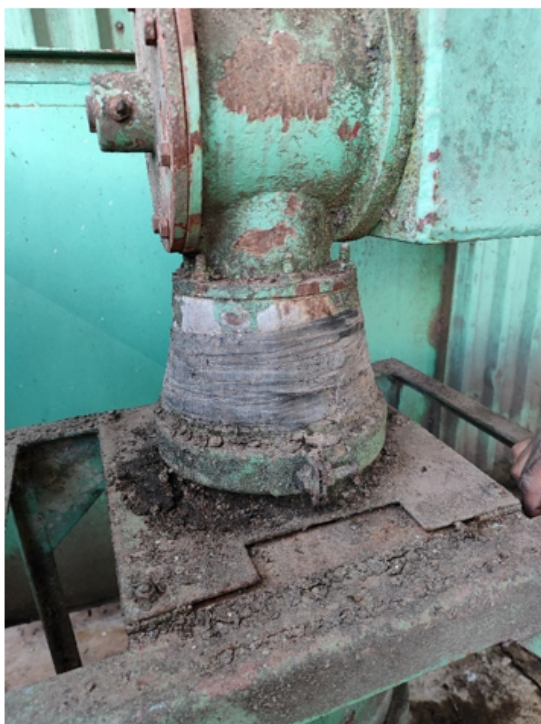
Fig. 6. Desgaste do funil de coleta de material particulado, com avançado grau de oxidação, causando derramamento do pó coletado nos ciclones.
