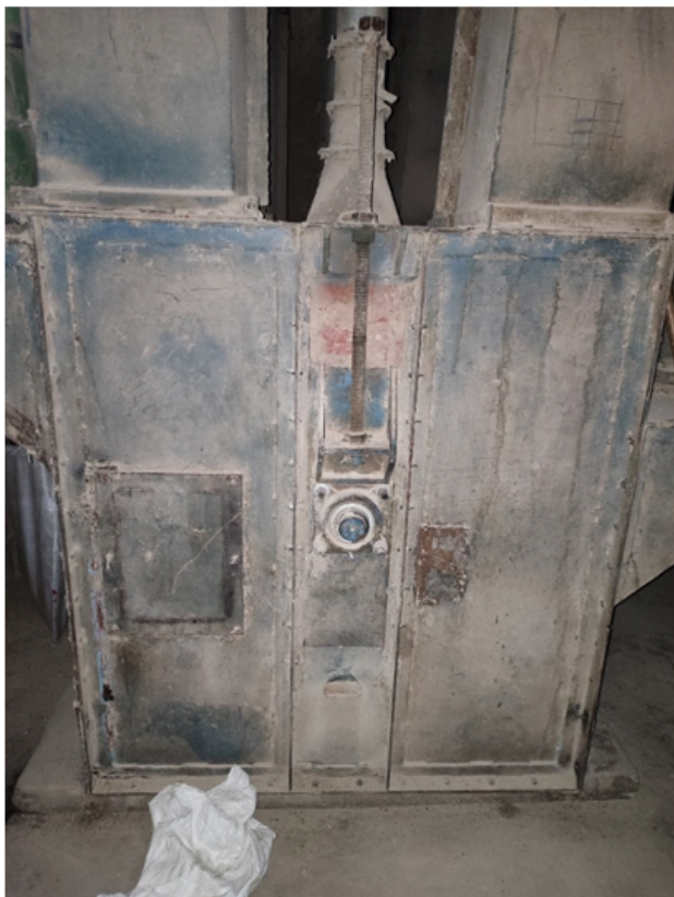
Fig. 4. Situação das chapas da base do elevador de canecas, evidenciando emendas e soldas de chapas na tentativa de tampar furos e evitar vazamentos de produtos.
