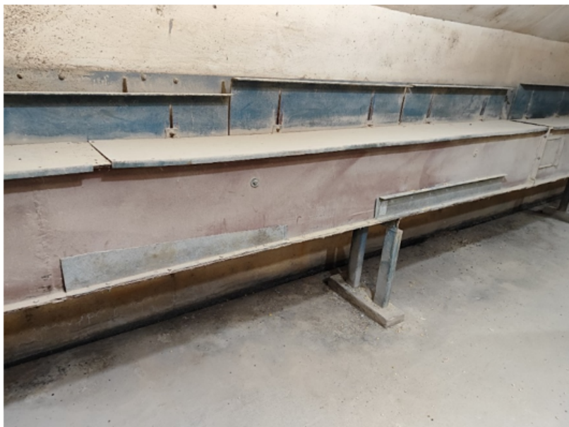
Fig. 1: Aspecto das chapas laterais do redler, com chapas emendadas na tentativa de tampar furos e evitar vazamentos de produtos.
