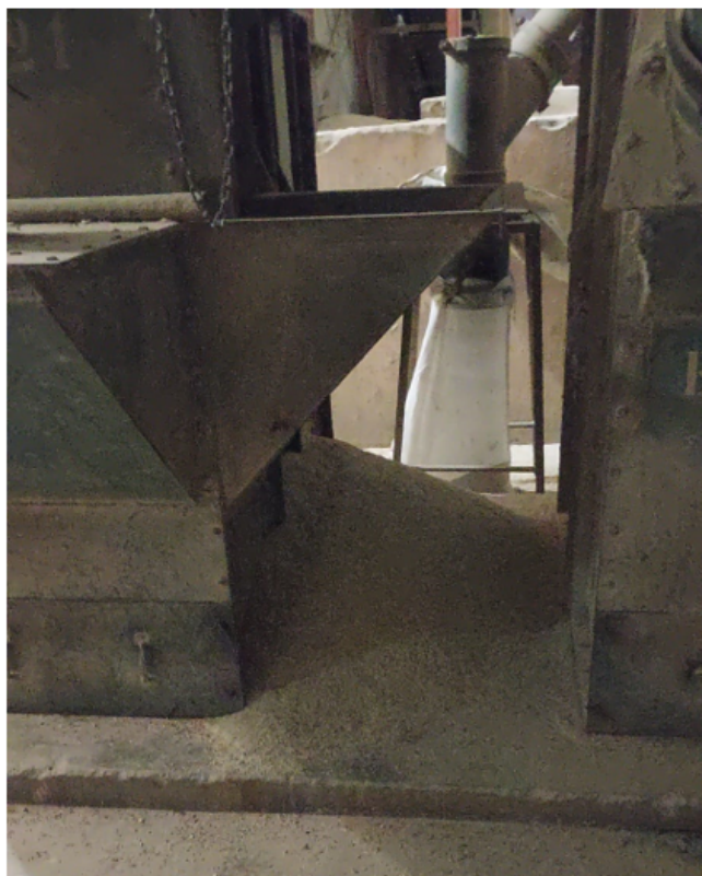
Fig. 3. Vazamento de produto devido a furo na chapa da base do elevador de canecas.
