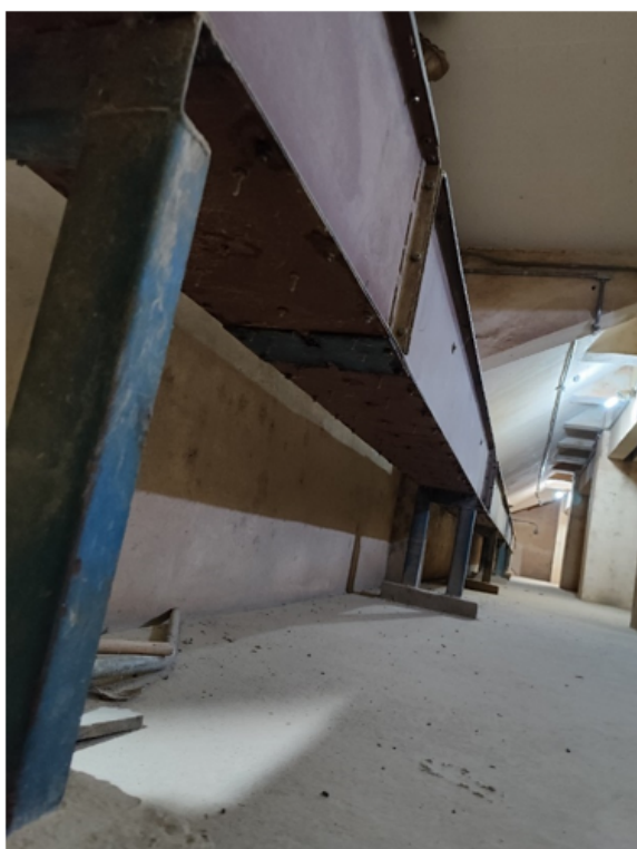
Fig. 2: Aspecto do fundo das calhas metálicas do redler, evidenciando pontos de ferrugem e emendas paliativas.
