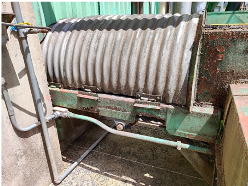
Fig. 5. Aspecto da longarina da correia transportadora, com vários pontos oxidados
