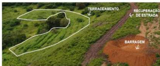
Foto 02 – Vista aérea de terraceamento, barragem e recuperação de estrada vicinal em entorno de nascente.
