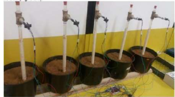
Fig. 2. Tensiômetros eletrônicos instalados em vasos preenchidos com Latossolo Vermelho - Amarelo
