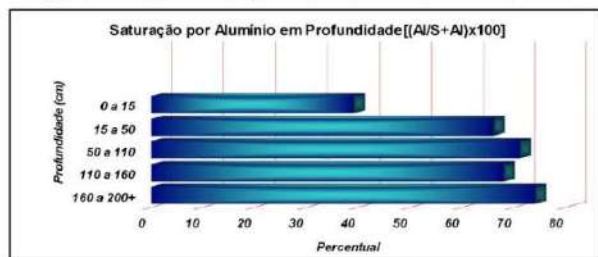
Figura 3. Saturação de Alumínio em Profundidade no Perfil de Solo
