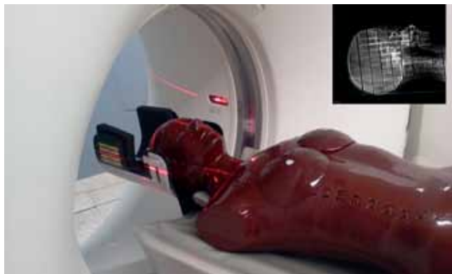
Avaliação da dose em simulador antropomórfico de pacientes submetidos a exames por tomografia computadorizada.
