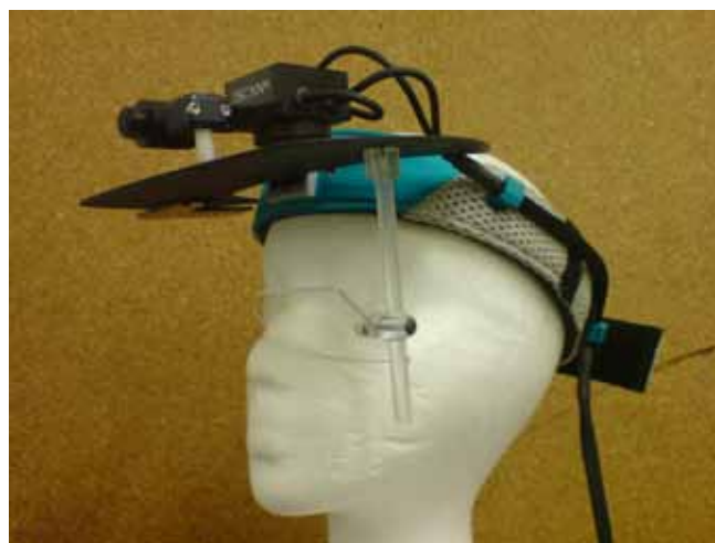
Equipamento para rastreamento do olhar em pesquisas experimentais sobre comportamento de observação
