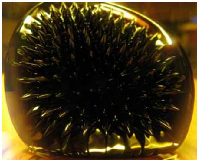
Fluido Magnético: imagens de nanopartículas magnéticas em água
