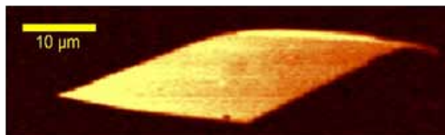
Imagem espectroscópica de uma camada com espessura de um átomo (grafeno)
