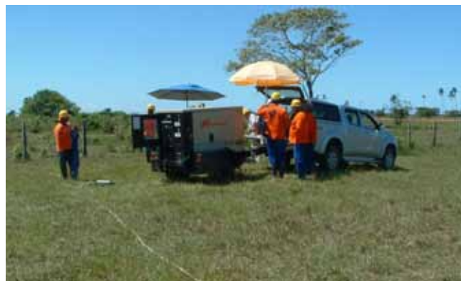
Unidade de transmissão do equipamento eletromagnético em operação
