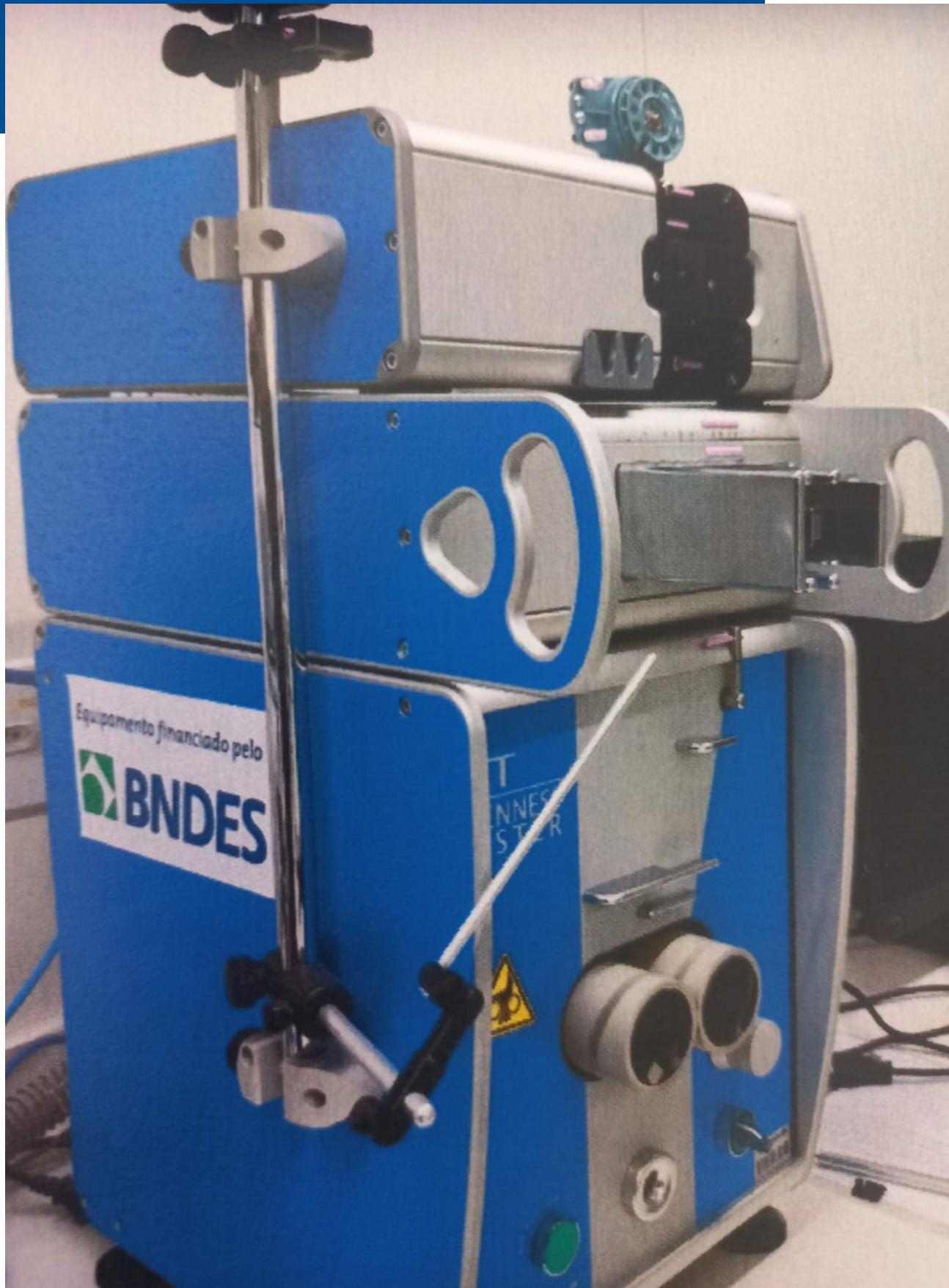
Equipamento Para Teste De Uniformidade De Massa E Imperfeições De Fios Naturais, Artificiais E Sintéticos.
