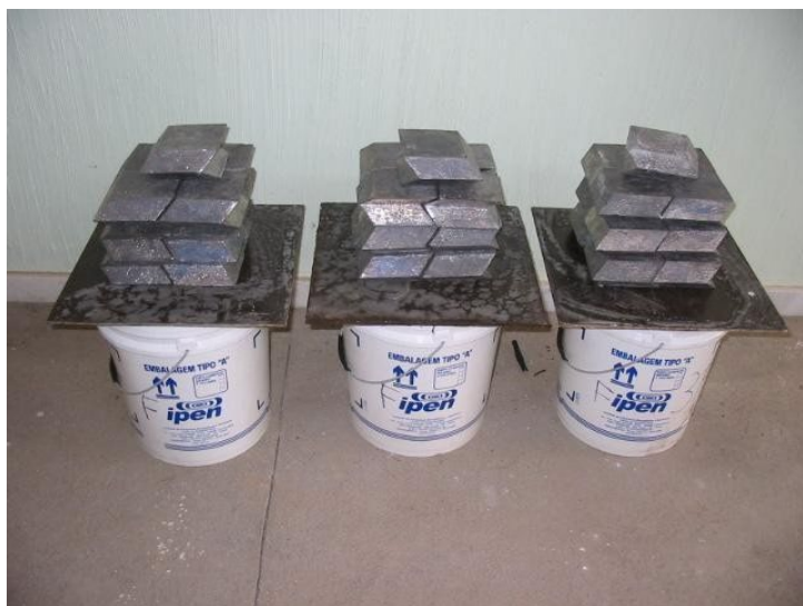
Ensaio de compressão em embalagens de radiofármaco
