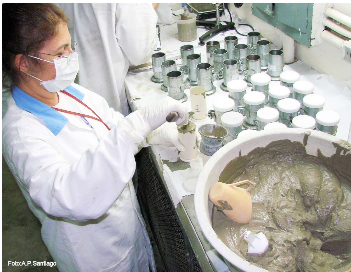
Cimentação de embalagens de rejeitos radioativos
