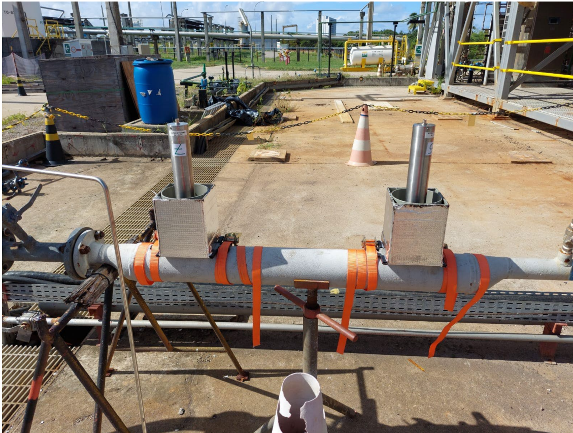
Detecção de fugas em trocador de calor
